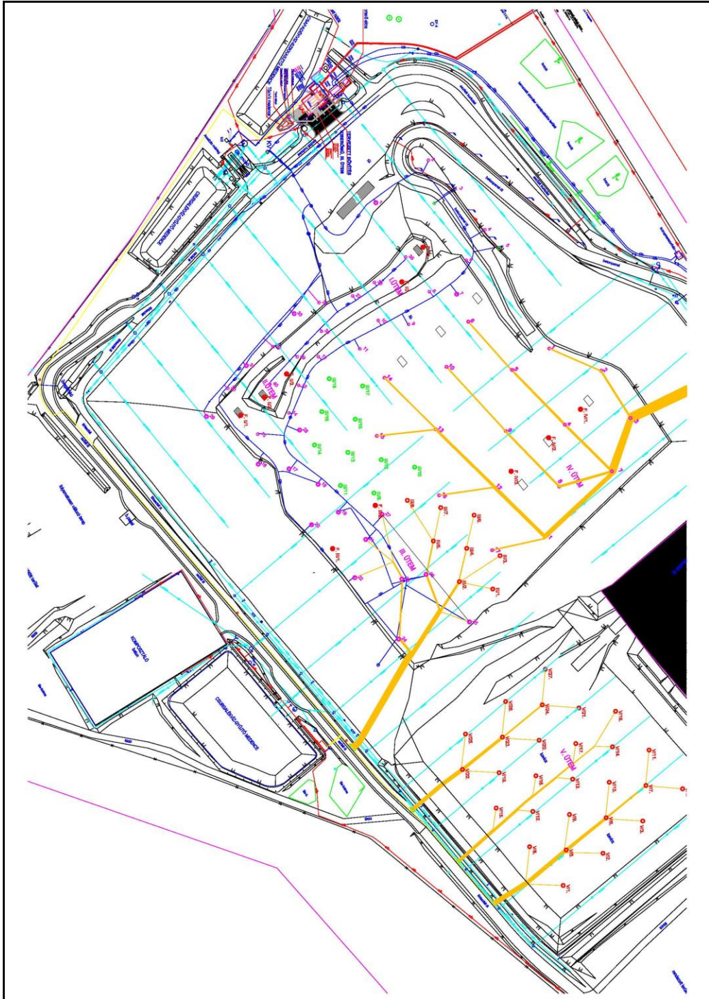
15. ábra: A depónia kiépített hőmérséklet és depógáz monitoring rendszere
