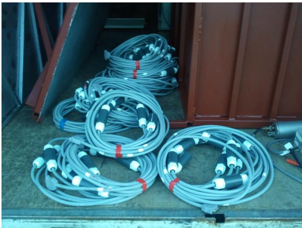
14. ábra: Az elkészült 10 mérőhelyes hőmérséklet-eloszlás mérő szondák.
